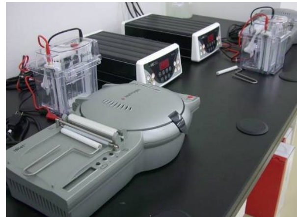
SDSポリアクリルアミドゲル電気泳動槽 ウエスタンブロット装置
